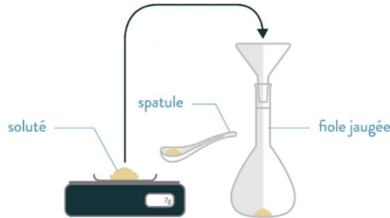
Préparer une solution par dissolution d'un solide
