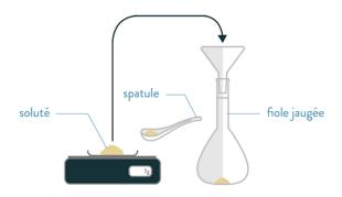
Préparer une solution par dissolution d'un solide
